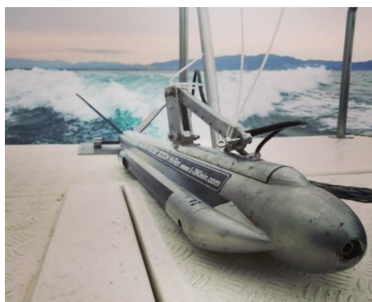
Figura 3. Sonar d'escombrat lateral emprats (Sonar Klein 3000H).
